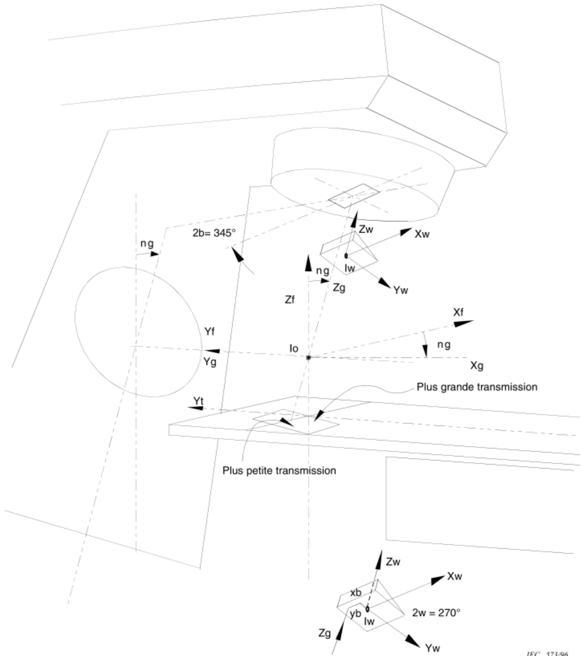
Figure 7 – Rotation ( \theta_w = 270^\circ ) et translation du système de coordonnées du FILTRE EN COIN X_w, Y_w, Z_w dans le système de coordonnées du DISPOSITIF DE LIMITATION DU FAISCEAU X_b, Y_b, Z_b , le système de coordonnées du DISPOSITIF DE LIMITATION DU FAISCEAU ayant tourné d'un angle \theta_b = 345^\circ (voir 2.5)
