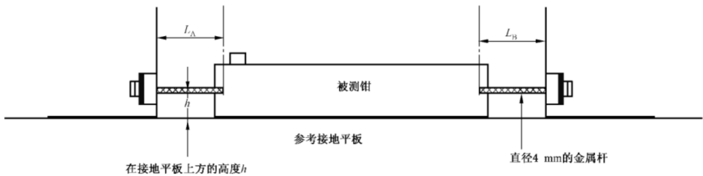
图 A.5 插入被测钳的试验夹具
