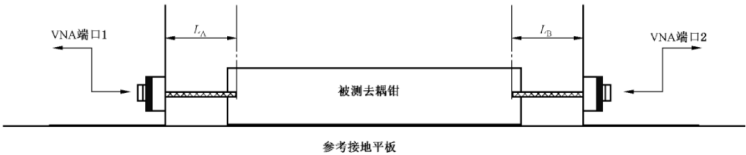
图 A.12 去耦钳特性的测量布置
