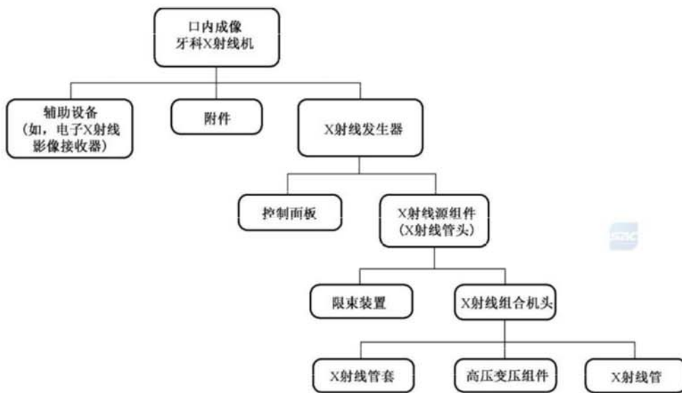
图 BB.1 口内成像牙科 X 射线机结构
