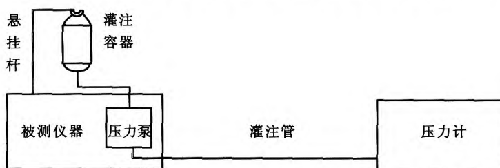
图2 压力灌注设备的试验方法
